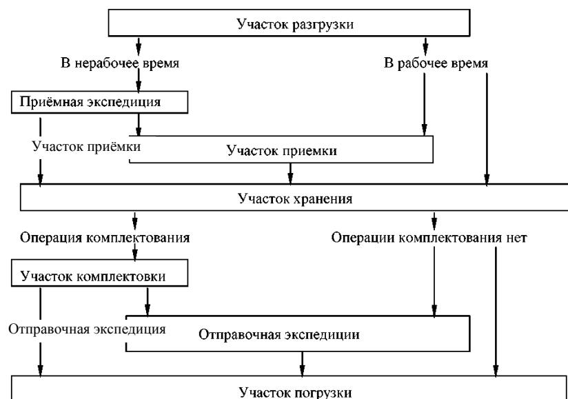
Рис. 1. Принципиальная схема материального потока на складе
